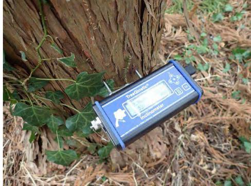
図2-4.2 傾斜計(インクリノメーター)
